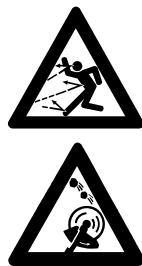
作業区域の確認：石や金属部品などの硬い物体が、カッティングブレードによって横に飛び散ることがあります - 15 m を超える距離ですら、ケガの危険があります！ - カッティングアタッチメントや他の器物（駐車中の車両、窓など）を損傷することもあります。
