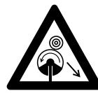
金属製カッティングアタッチメントを使用する場合、回転しているブレードが硬い障害物（木の根や枝、切り株、石など）に当たるとキックバックの危険があります。機械は、アタッチメントの回転方向と反対の、右または後方に跳ね返ります。
