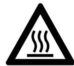
作業時にギヤボックスが熱くなります。絶対にギヤボックスに触れないでください - 火傷の危険があります！
